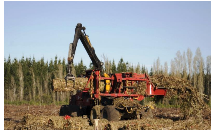
2- Processamento dos Resíduos (Enfardamento)
